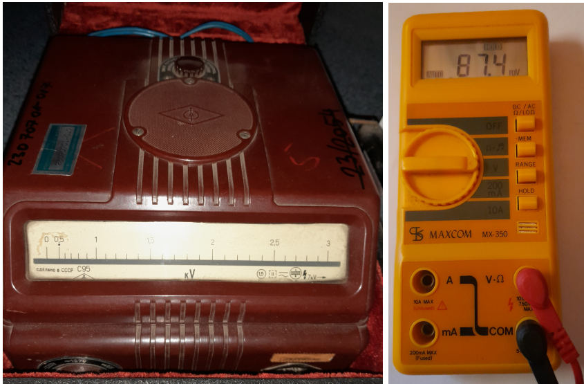
1.21. ábra. Balra: Klasszikus kilovoltmérő nagy feszültségre. Jobbra: Egyszerű univerzális elektromos mérőműszer
