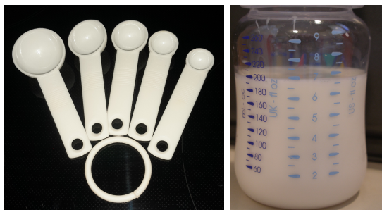
2.3. ábra. Balra: amerikai receptekhez nélkülözhetetlen mérőkanalak: egy és fél evőkanál, egy, fél és harmad teáskanál. Jobbra: babatápszeres mérőpohár milliliterben, valamint angol és amerikai unciában, vegyük észre az utóbbiak különbségét. Jól látszik, hogy az angol pint több, az amerikai kevesebb fél liternél
