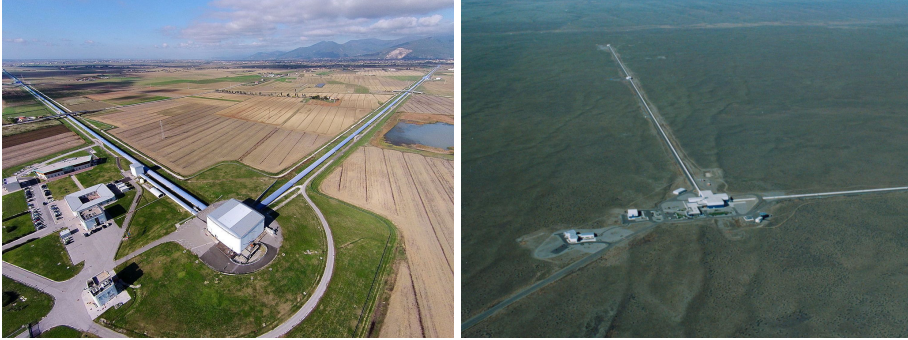
4.8. ábra. A Pisa melletti olasz VIRGO és az egyik amerikai LIGO lézer-interferenciás gravitációs megfigyelőállomása: a baloldali VIRGO karjai 3 km, a jobboldali LIGO-é 4 km hosszúak
