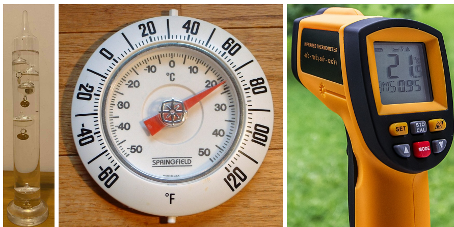
1.13. ábra. Balról jobbra: Galilei hőmérő a különböző hőmérsékleteket jelző, úszó buborékokkal; asztali hőmérő Fahrenheit és Celsius skálával; modern digitális infravörös hőmérő.
