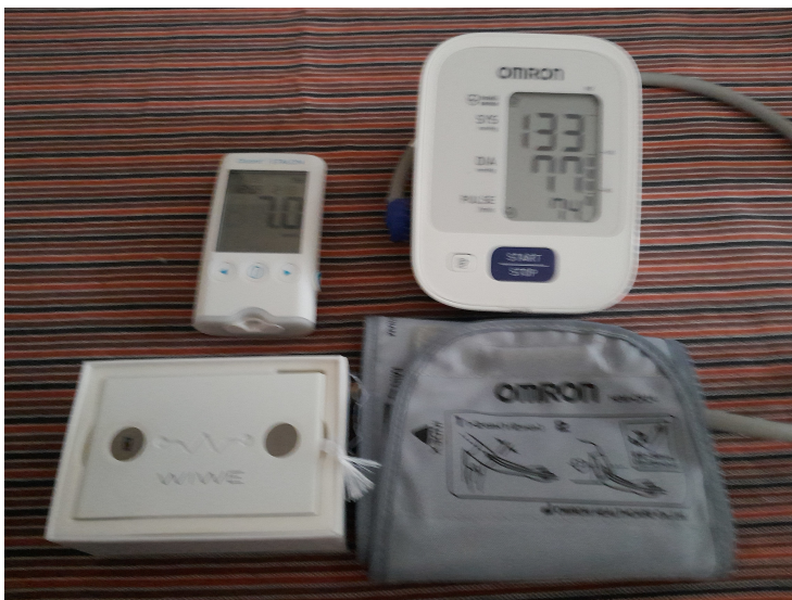
4.16. ábra. Háztartási orvosi műszerek, balra fenn vércukorszint, alatta EKG, jobbra vérnyomás mérése
